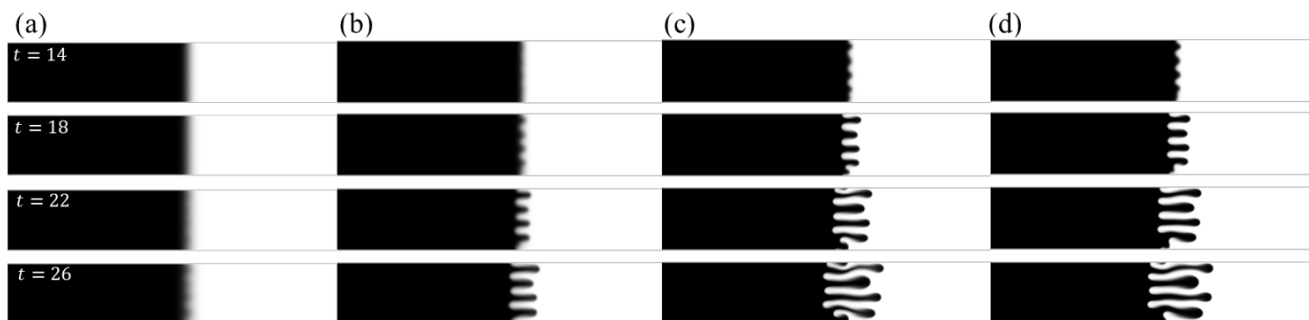
図1 有効界面張力存在下のVFシミュレーション結果 Pe が(a)500、(b)1000、(c)2500、(d)3800 のときの結果で、上から下に向かって時間が経過している。(b)から(c)にかけて指幅が小さくなっているように観察され、(c)から(d)にかけて指幅が大きくなっているように観察された。
